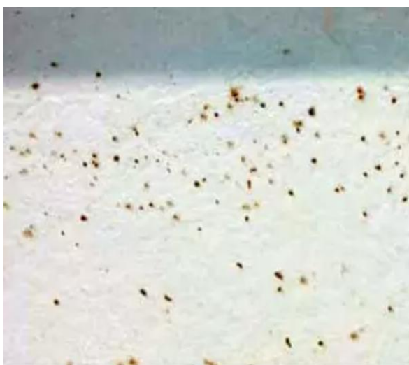
Points brun-rouge : suspicion de particules métalliques ou limaille.
